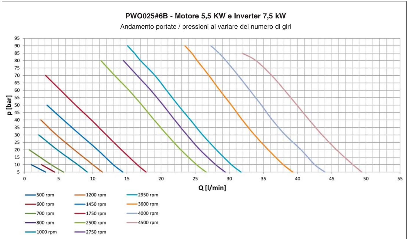
**Esempio di curve andamento portata / pressione al variare della velocità.**
